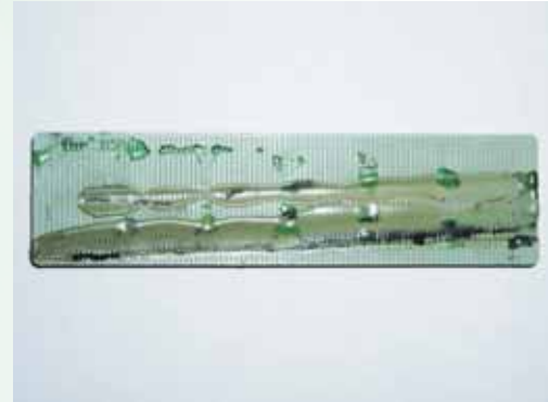
Abb. 6 Klotz nach schädlichen Wechselwirkungen
